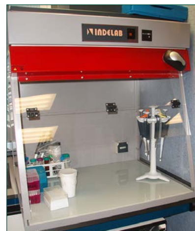
Figura 14. Campana química para manejo de sustancias químicas volátiles.
