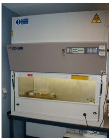
Figura 13. Campana de seguridad biológica. En su interior se encuentra una jaula para roedores.
