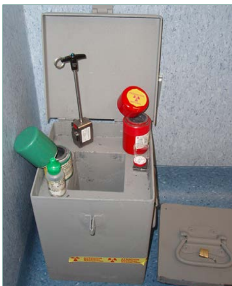
Figura 15. Almacenamiento de diversas fuentes de calibración. Fuentes de ^{37}\text{Cs} (6,3 MBq, de color verde) y ^{22}\text{Na} (3,7 MBq, disco rojo/blanco) con sus blindajes de origen (de los mismos colores) y fuente de ^{137}\text{Cs} (370 MBq, en el centro de la figura) con el contenedor de 5 cm espesor de Pb (pozo de color gris). Con este blindaje la fuente de ^{137}\text{Cs} puede estar en la misma sala que el tomógrafo PET.
