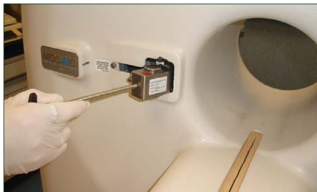
Figura 2. Manipulación a distancia de la fuente de calibración de 370 MBq de 137 Cs del equipo PET Mosaic.
