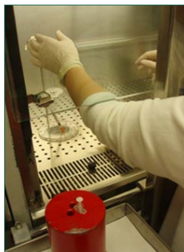
Figura 7. Preparación del radiotrazador en una campana de flujo laminar dotada de un activímetro y blindajes. En primer término se muestra una jarra de plomo para el traslado de las jeringas. El operador está detrás de un blindaje móvil.
