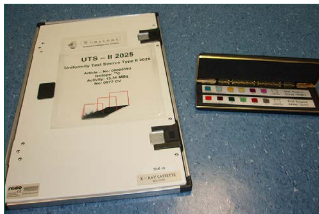
Figura 1. Fuentes de referencia utilizadas en los estudios de autorradiografía para la calibración y cuantificación de los estudios.
