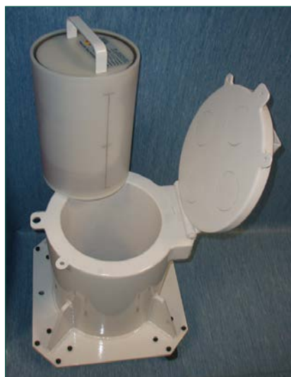
Figura 16. Fuente cilíndrica de ^{68}\text{Ge} (74 MBq) con su contenedor específico de 4 cm de Pb, para la calibración de un tomógrafo PET de campo transaxial grande.
