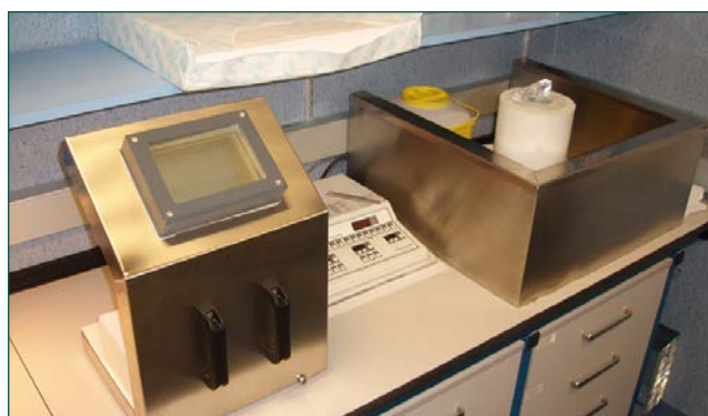
Figura 6. Área de preparación del radiotrazador dotada de blindajes y de un activímetro.
