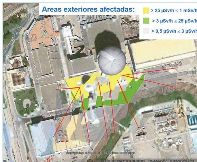
Figura 6. Áreas exteriores afectadas por el traslado de la tapa.
