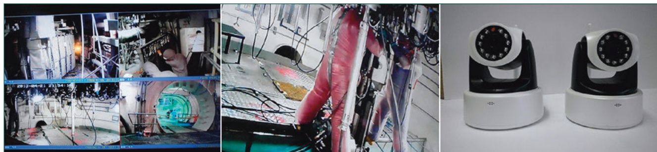
Figura 16. Cámaras IP para supervisión de trabajos en zona de baja radiación y sistemas audio-vídeo.
