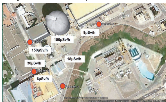
Figura 7. Tasas de dosis medidas durante el traslado de la tapa sustituida por áreas exteriores.
