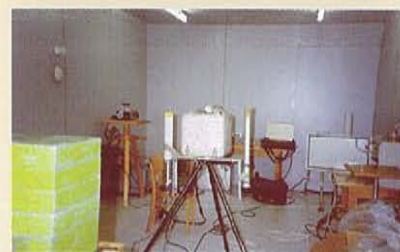
Disposición de diversos equipos durante los experimentos realizados en el laboratorio de fondo ultrabajado UDO-PTB (Alemania). Este laboratorio está ubicado a 925 m de profundidad en una mina de sal y la tasa de dosis es inferior a 1 nSv/h
