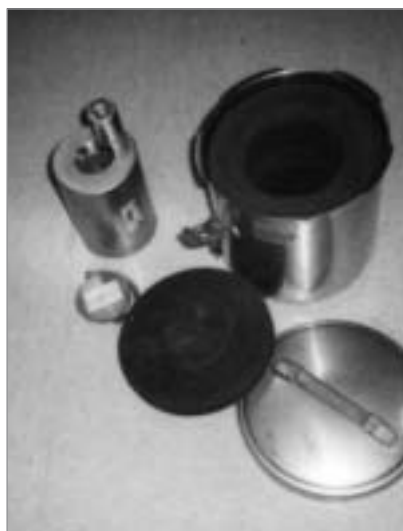
Figura 4. Contenedor de transporte de la FDG
