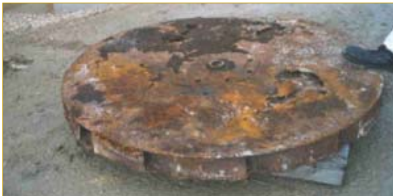
Pieza de acero contaminada con Ra-226. Steel part contaminated with Ra-226.
