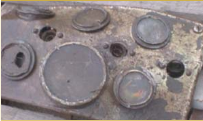
Panel con indicadores con pintura radioluminiscente conteniendo Ra-226. Board with indicators with radioluminescent paint containing Ra-226.
