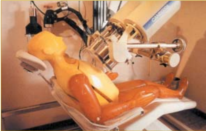
Figura 1: Detectores LE Germanio del contador de cuerpo entero del CIEMAT. Los detectores están situados sobre un maniquí de calibración, en el proceso de determinación de la eficiencia de detección para una geometría particular.
