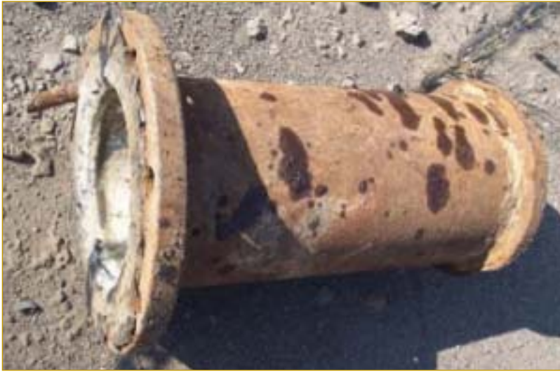
Tubo contaminado con Ra-226. Tube contaminated with Ra-226.
