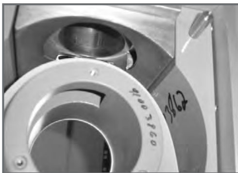
Figura 1: Detalle del blindaje del detector, mostrando la ranura de detección en un sector angular de 135° y la entrada del aire en la parte superior.
