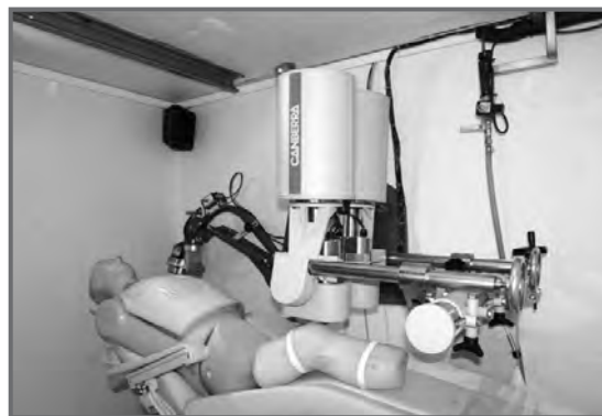
Fig 1. Sistema de Detección LE Ge para la Determinación de ^{241}\text{Am} en Rodilla en el CRC.
