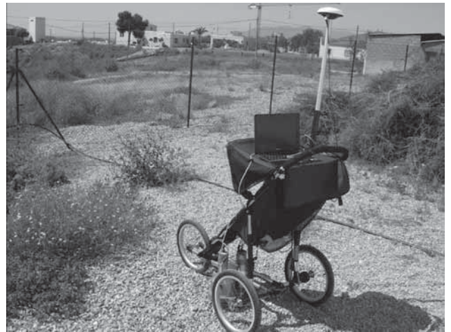
Figura 2: Sistema DINARAD configurado para su uso en un carro con un detector de NaI:TI de 7.5x7.5 cm, un detector FIDLER, el equipo DGPS con su antena y el ordenador portátil
