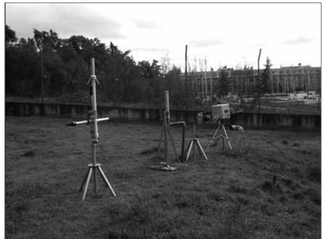
Figura 6: Sondas para la medida en continuo de la tasa de dosis en la estación ESMERALDA. De izquierda a derecha: Red Gamma (vertical), REA y cámara de ionización presurizada.
