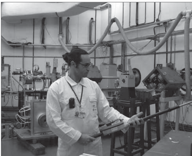
Figura 2.- Técnico de PR realizando medidas en el interior del Ciclotrón
