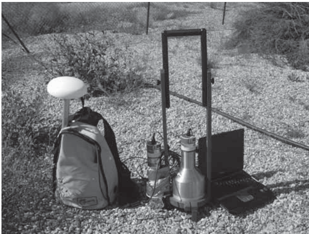
Figura 1: Sistema DINARAD configurado para su uso a pie con un detector de NaI:TI de 7.5x7.5 cm, un detector FIDLER, el equipo DGPS con su antena y el ordenador portátil
