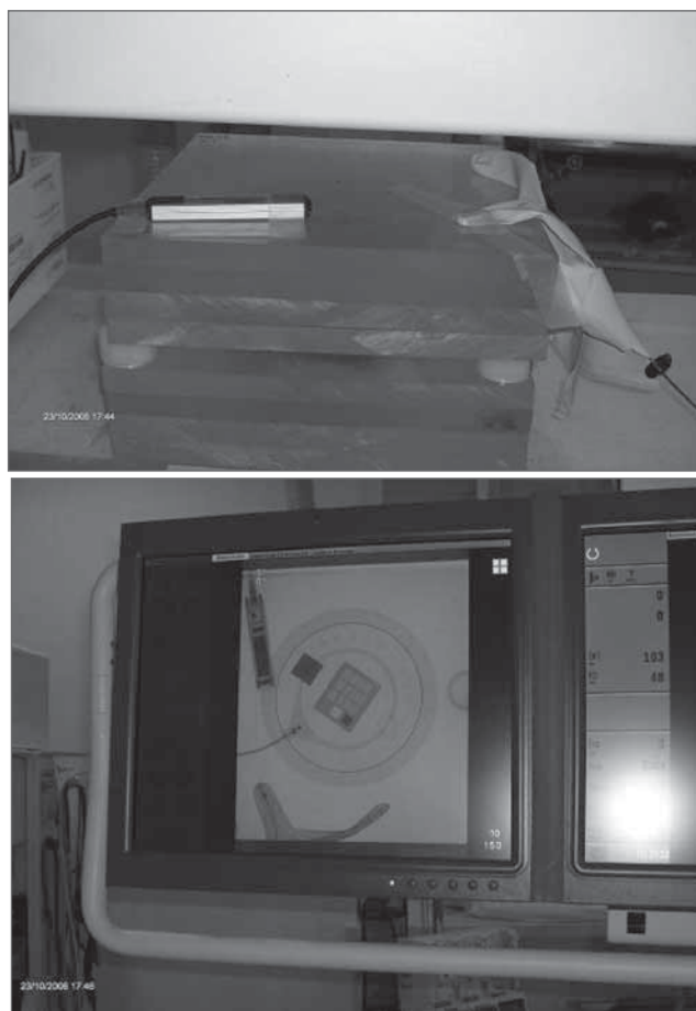
Figura 1. Posición del guante en el segundo punto de medida e imagen registrada en el monitor de sala
