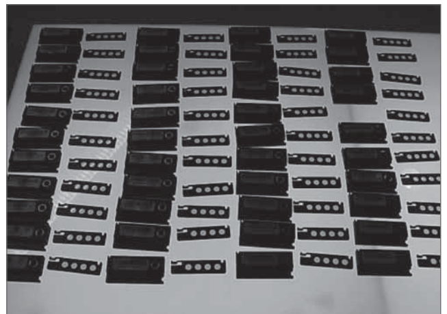
Figura 4: Dosímetros durante el proceso de borrado sobre un negatoscopio convencional.
