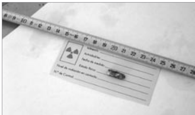
Figura 6: Fuente de Co-60 sin blindaje (1,9 MBq).
