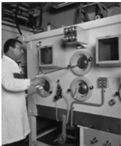
Recinto CORINA para el manejo de emisores gamma de alta actividad.
