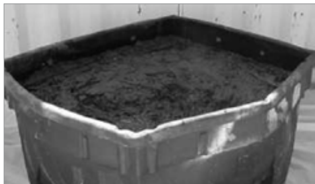
Figura 3. Cubeta de lodos obtenidos tras el purgado de un depósito dedicado al almacenamiento de crudo de petróleo, justo tras su extracción en una plataforma marina y la separación de su contenido en agua.
