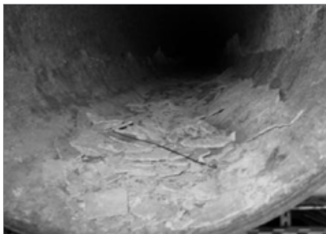
Figura 2. Costras o "scales" adheridas a una tubería en una industria NORM paradigmática: la dedicada a la extracción de petróleo. Dichas "scales" se encuentran fundamentalmente enriquecidas en ^{226}\text{Ra} y ^{228}\text{Ra} .
