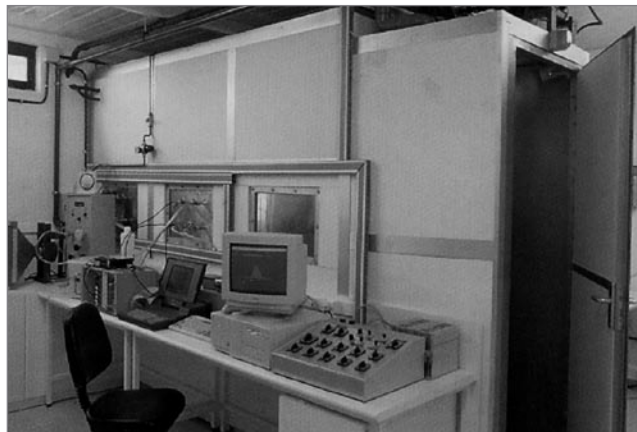
Figura 1: La calibración de los detectores o equipos en una cámara de radón trazada a un laboratorio de referencia y la participación en ejercicios de inter-comparación son imprescindibles para garantizar la calidad de las medidas. En la imagen, cámara de radón de la Universidad Politécnica de Catalunya (UPC).
