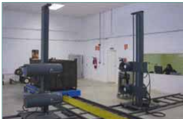
Figura 8. Box Counter, tecnología clave en la metodología de desclasificación de materiales.
