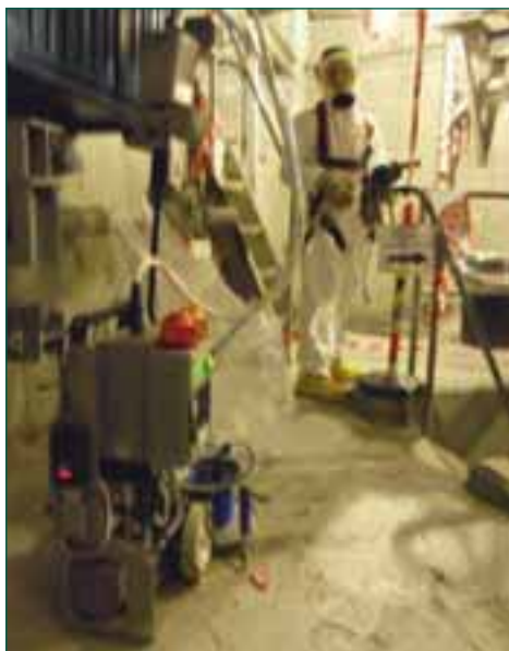
Figura 1. Baliza de control de la contaminación ambiental en una zona de trabajo.
