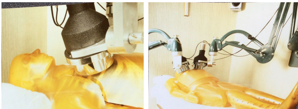
Detectores Phoswich y maniquí de calibración (LLNL) para la medida in-vivo de actínidos en pulmón
