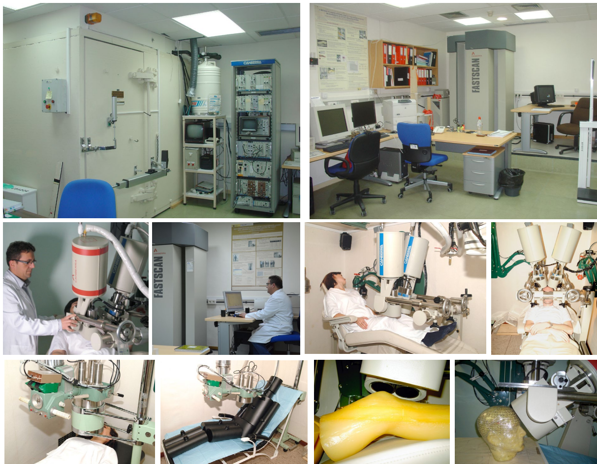
El Laboratorio del Contador de Radiactividad en el siglo XXI. Medida in-vivo de actínidos en pulmón, productos de activación y fisión en cuerpo entero y Am-241 en hueso
