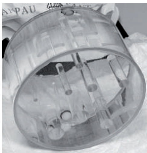
Figura 4. Maniquí no específico para la prueba de registro de imágenes SPECT-CT/PET-CT.
