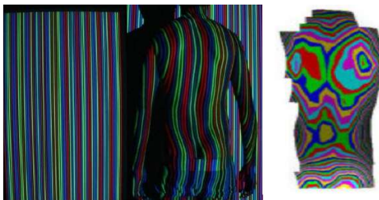
Figura: Patrón de luz estructurada proyectado sobre pantalla plana (izquierda) y sobre la espalda del deportista (centro). Topografía de la espalda (derecha).
