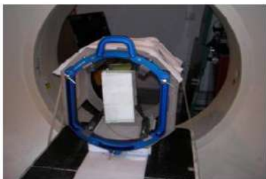
Fig1. Verificación geométrica del isocentro. Maniquí de la película con el marco estereotáxico.
