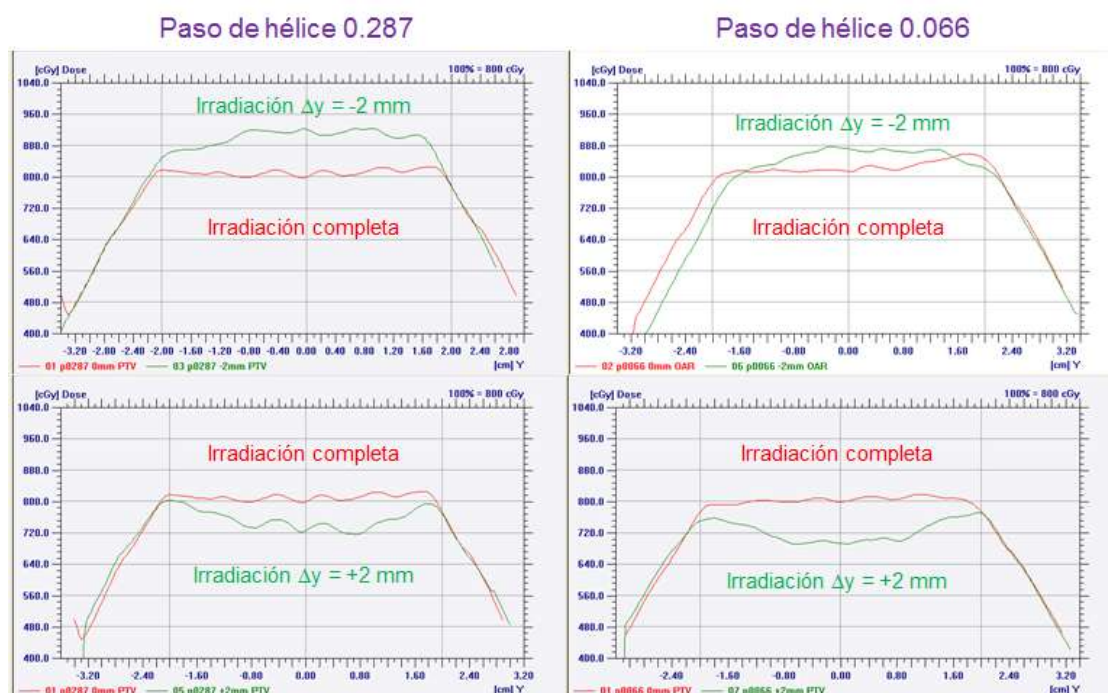
Figure 464: Perfiles de dosis longitudinales medidas con película radiocrómica.
