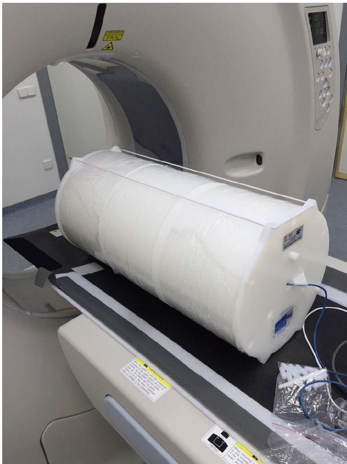
Figure 717: Maniquí TG200 con la cámara de ionización en el inserto central
