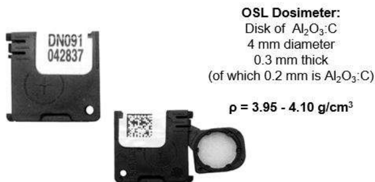
Figure 861: Dosímetro OSL nanoDot. A la derecha se muestra el cristal fotoluminiscente.
