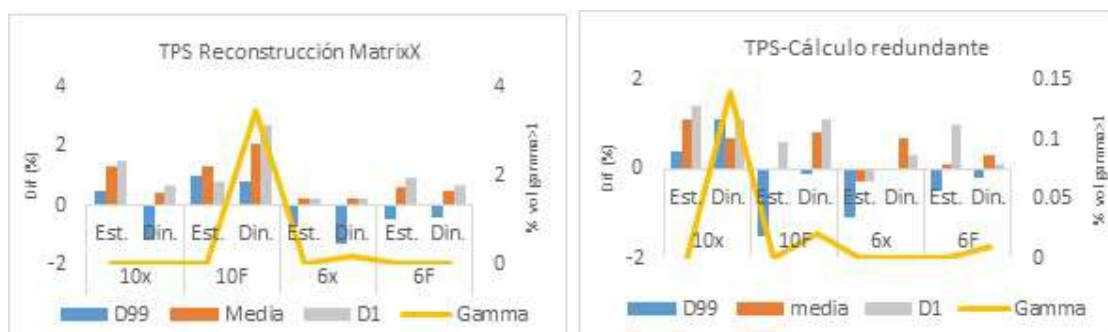
Figure 537: Gráficas comparando los valores obtenidos de D1, D99, Dmedia y función gamma entre el planificador y la reconstrucción del Matrixx a partir de las medidas realizadas (izquierda) y entre los valores del TPSy el cálculo redundante (derecha). "Est." corresponde a MLC estático y "Din." a MLC dinámico.
