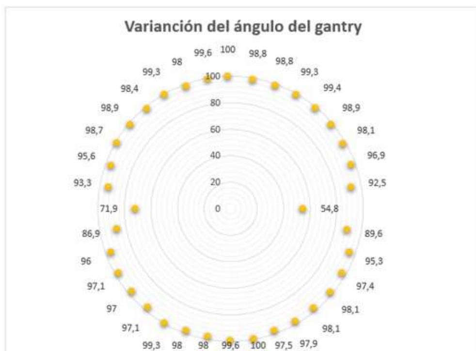
Figura 1. Representación del resultado de la función gamma para los diferentes ángulos de gantry.
