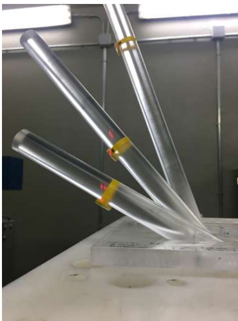
Figure 841: Geometría de irradiación angular en el plano sagital
