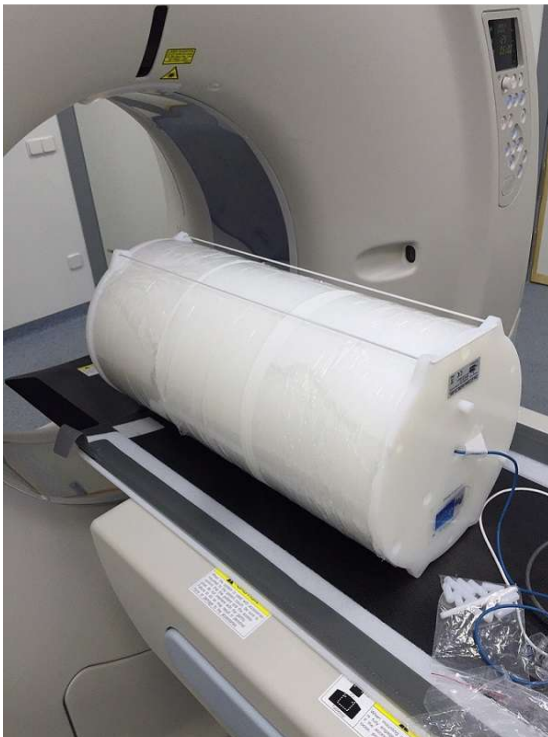
Figure 718: Dosis medida con cámara en el centro del maniquí TG200 para diferentes longitudes de estudio y parametrización de la función de equilibrio
