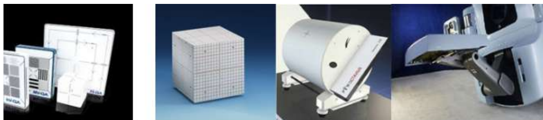
Figure 653: De izquierda a derecha: maniqués para realizar el machine QA, maniquí cúbico de RW3, maniquí Octavius, EPID
