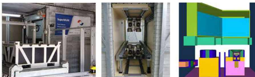
Figure 140: Figura 1: Imágenes del montaje de SuperMUM en el CIEMAT (izquierda), su cámara de medida (centro) y detalle parcial del modelo de Montecarlo utilizado en la simulación (derecha).
