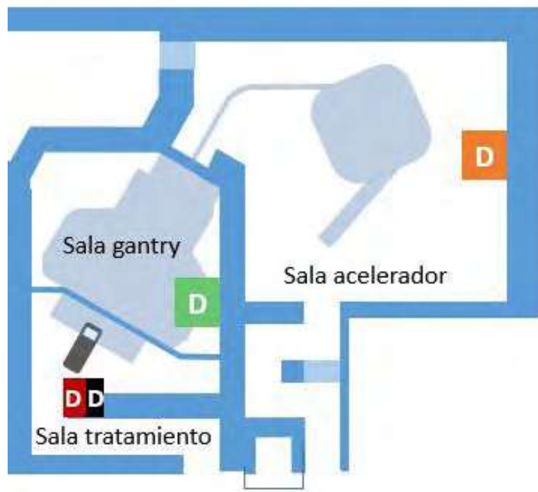
FIGURA 1. Disposición de los 4 detectores fijos de neutrones (D) para su verificación.
