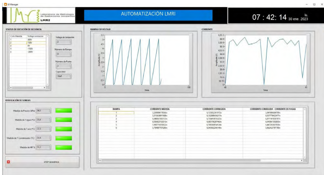
FIGURA 1. Panel frontal piloto resultado de la digitalización de la cadena de medida del laboratorio nacional de metrología en niveles de terapia.
