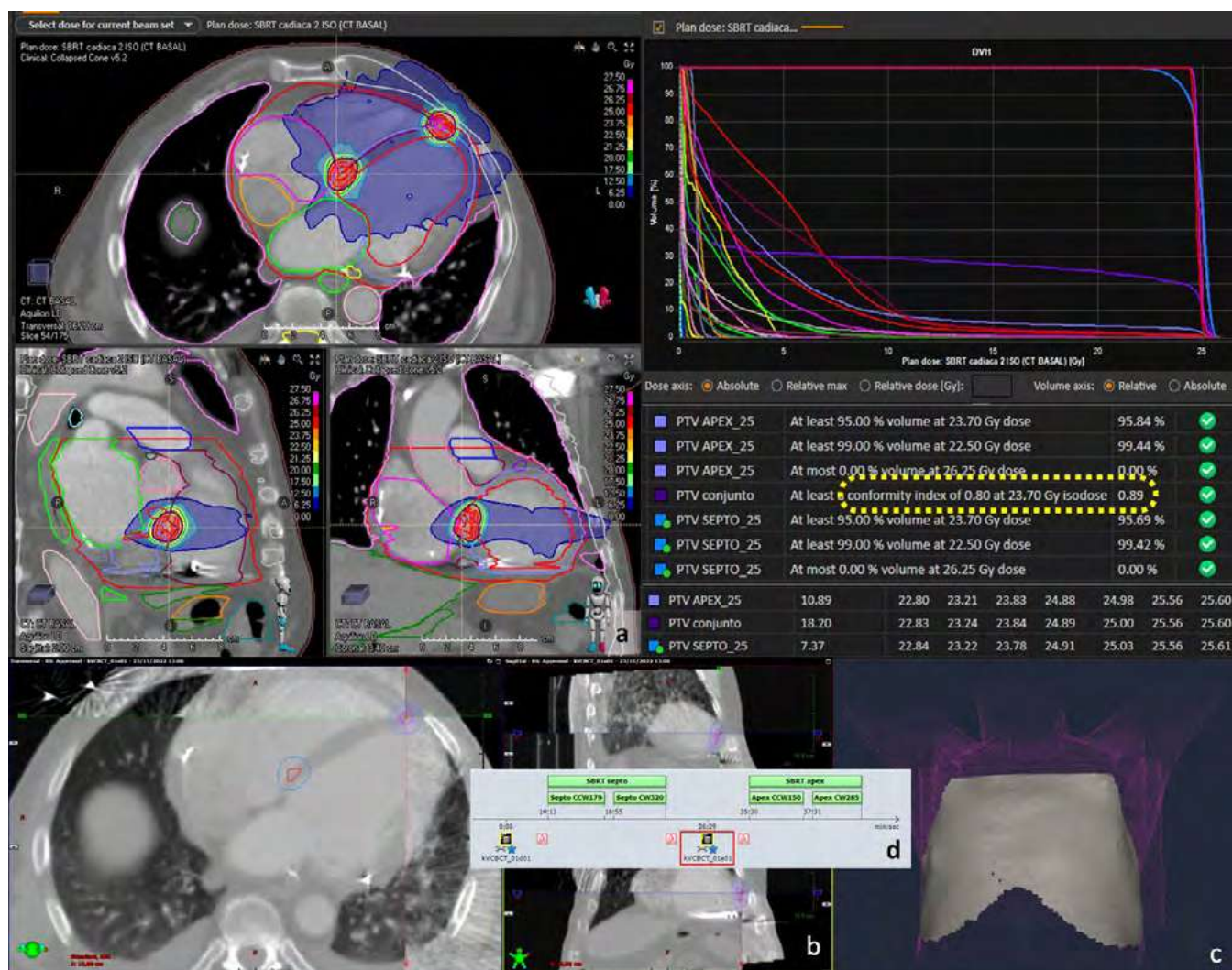
Figura 1. Distribución dosimétrica (a), localización mediante kV-CBCT (b), monitorización de la superficie (c), y esquema temporal de la sesión de tratamiento (d).
