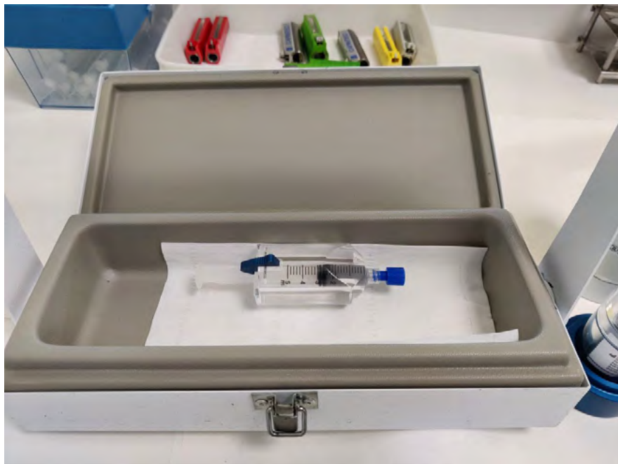
FIGURA 2: Jeringuilla con el P-32 y el blindaje donde es transportada.
