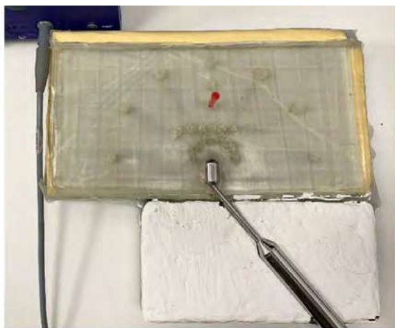
Figura 1. Setup experimental. En material bolus, se realizaron perforaciones para medir los perfiles de resolución angular, resolución espacial y sensibilidad. La sonda se coloca en un inserto unido al bolus para mantener la geometría sonda-fuente entre días.
