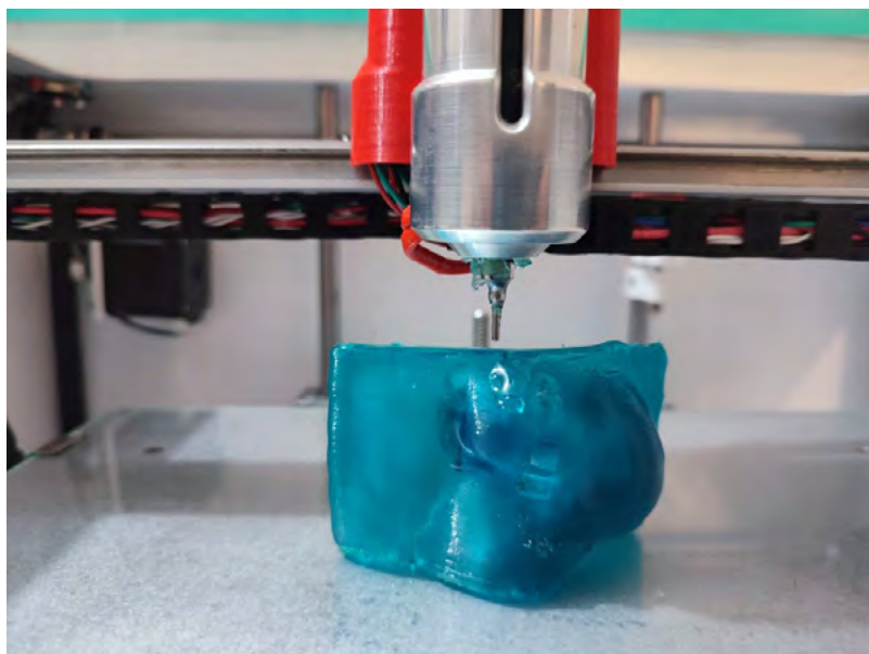
Fig 1. Fabricación de bolus 3D
