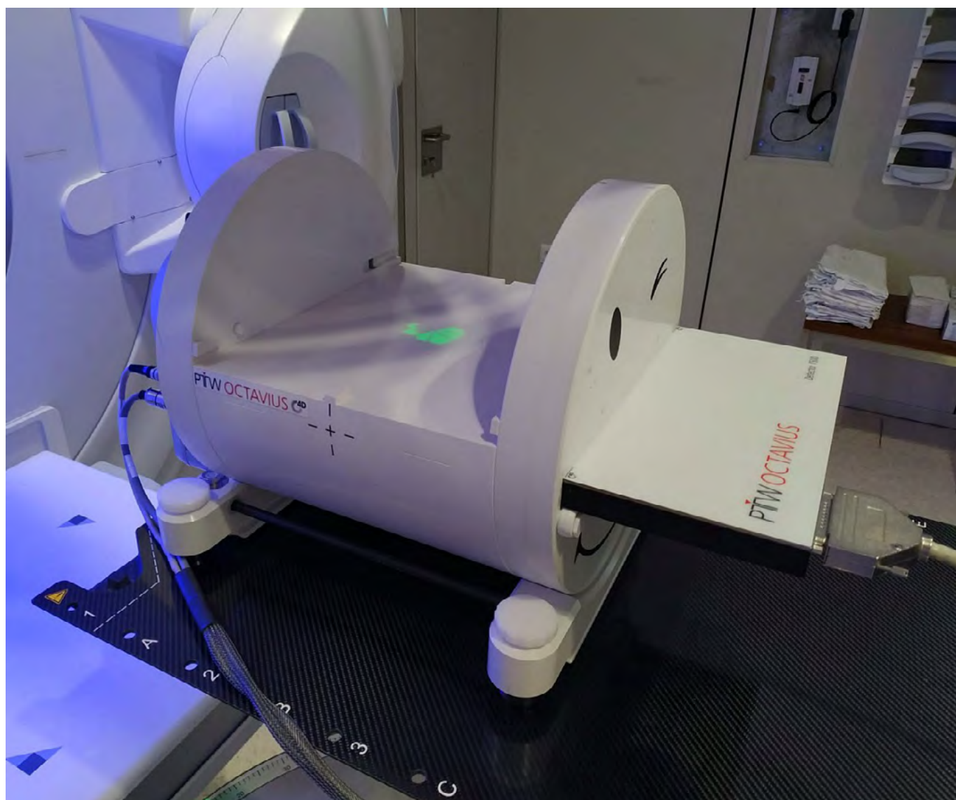
FIGURA 1: Unidad de rotación planar con un espesor tal que actúa como buildup para el detector, que se encuentra debidamente acoplado.
