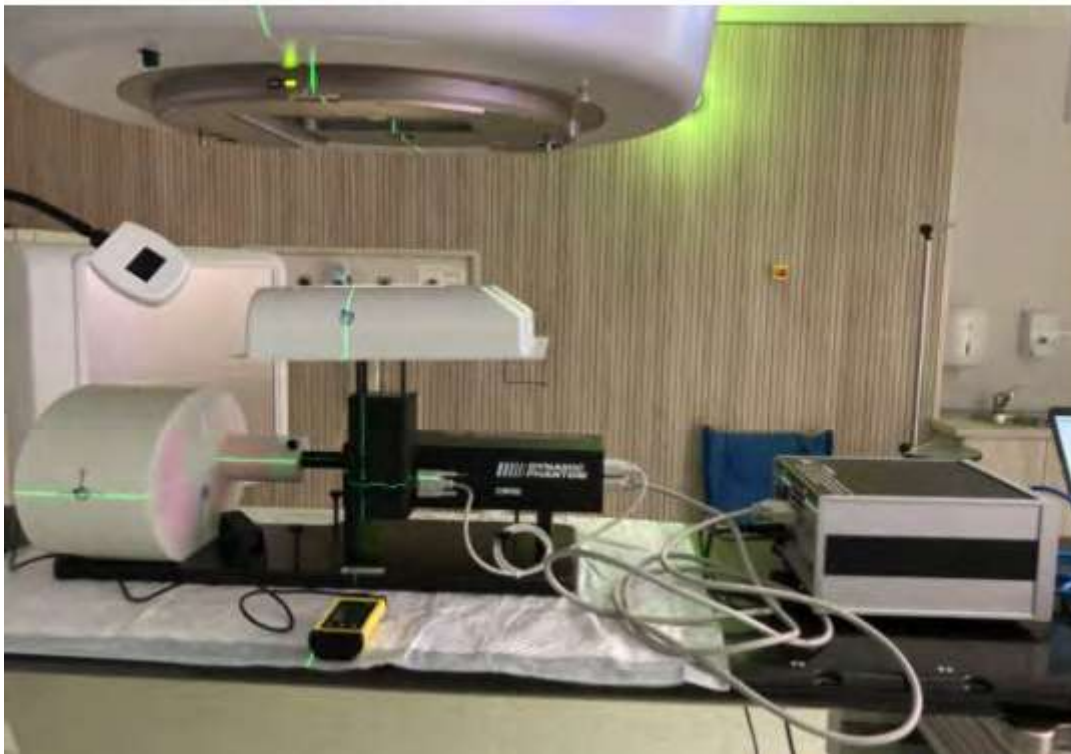
Imagen 1: Colocación del maniquí CIRS y piernas de VisionRT, para reproducir la respiración del paciente en DIBH guiada por superficie.
