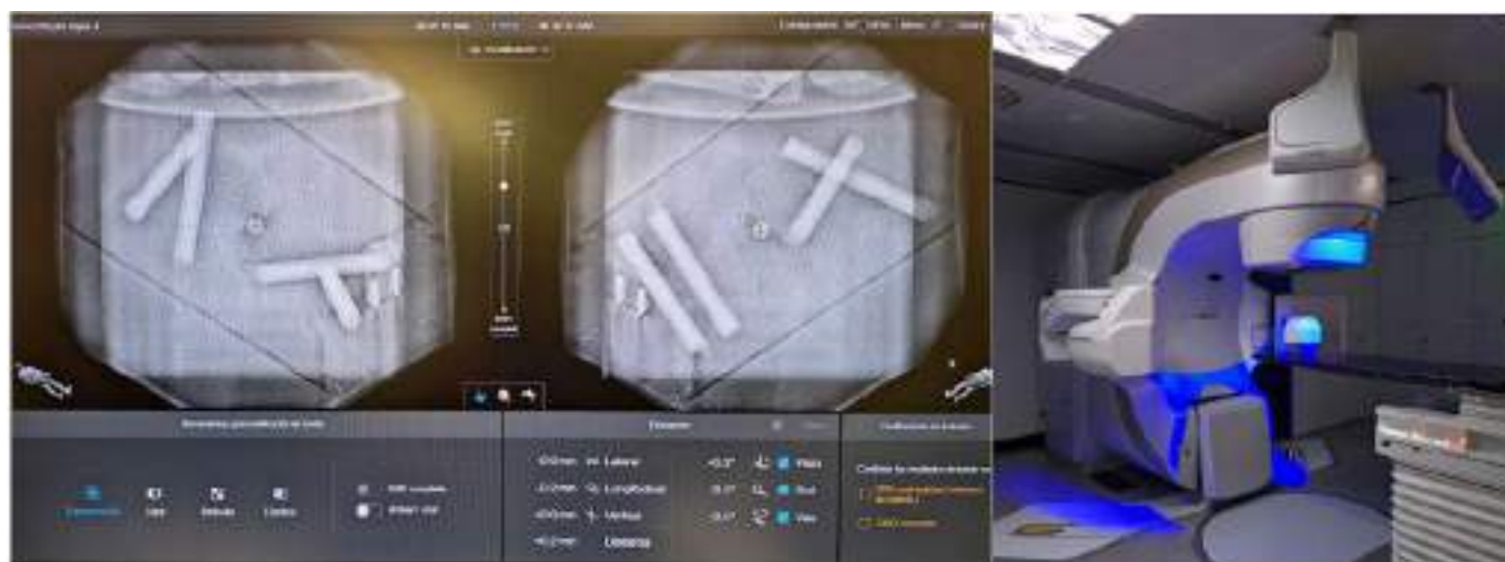
Fig. 1. Obtención de imágenes y posicionamiento del Maniquí Ruby en el isocentro del Exactrac.
