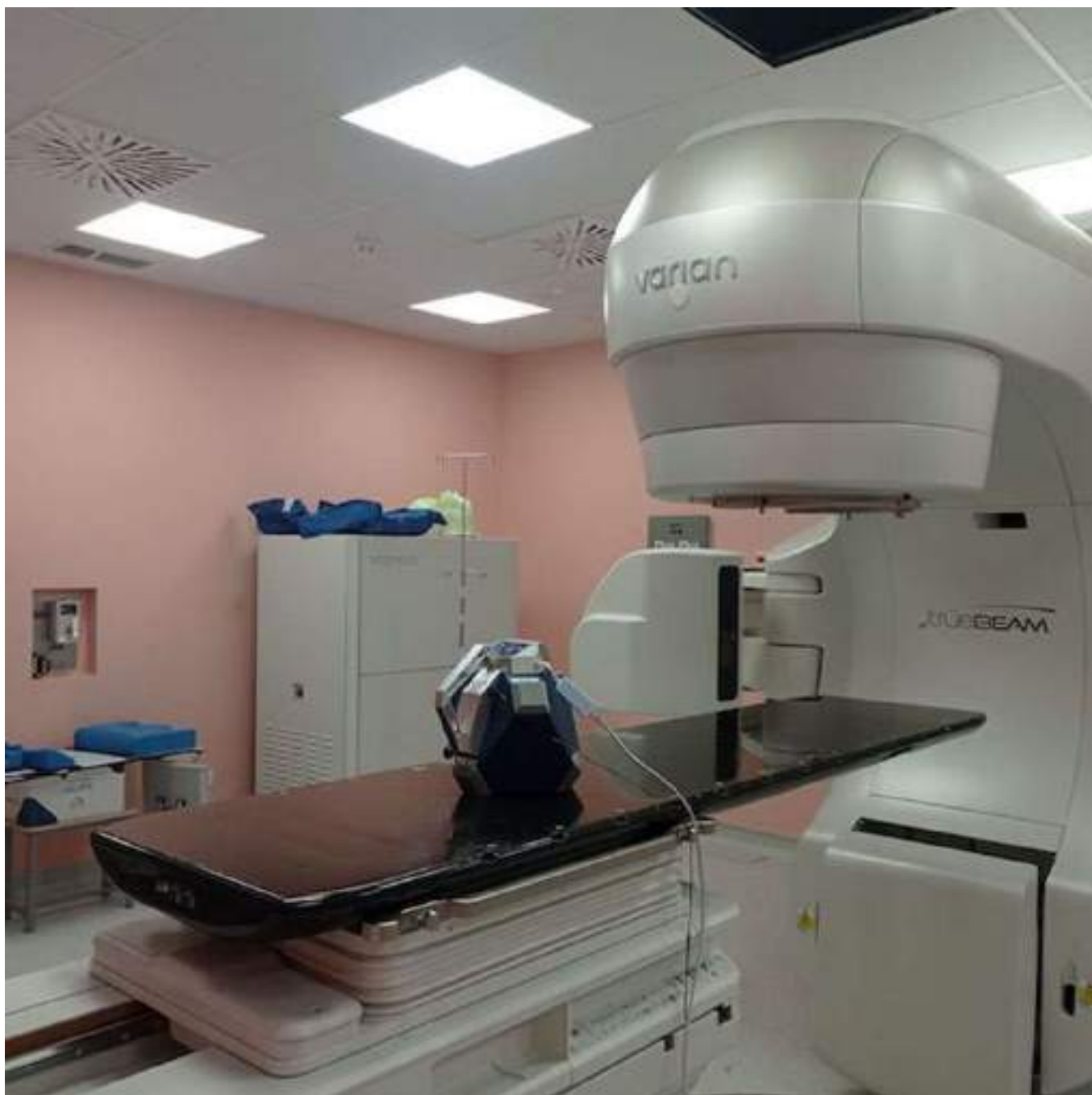
FIGURA 1. Disposición del detector DIAMON en uno de los puntos de medida del Búnker.
