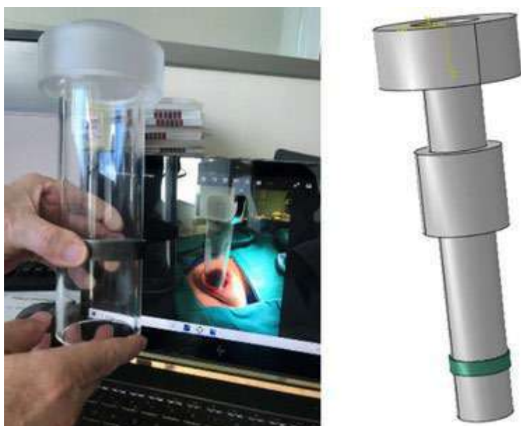
FIGURA 1: Aplicador con el anillo (izquierda) y geometría modelada (derecha).
