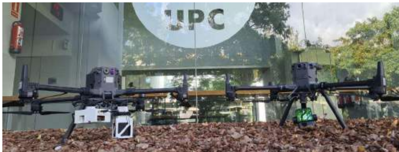
Fig 1. Fotografía del equipo DJI Zenmuse L2 montado en el gimbal del dron DJI M350RTK (derecha) y con el detector de NaI y electrónica (izquierda).
