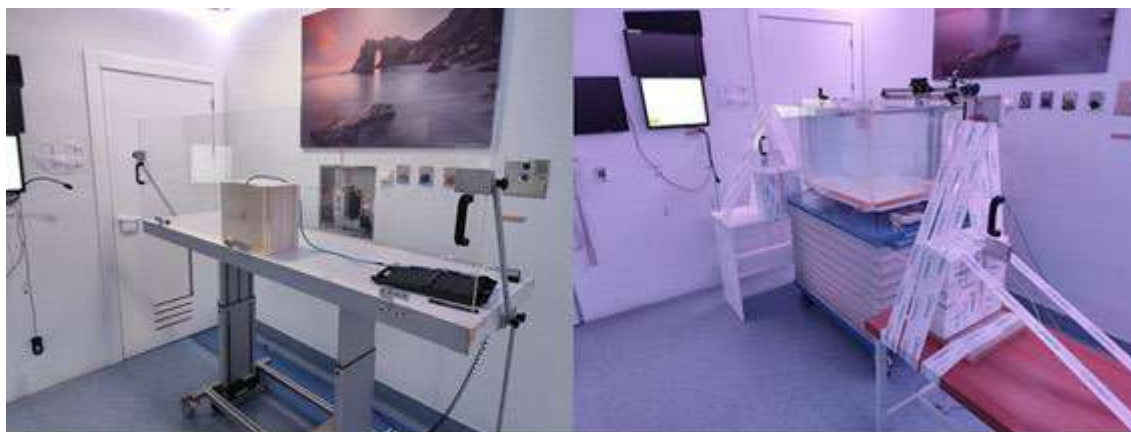
Figura 1. Montajes experimentales para la medida del PDD a) entre 0 y 15 cm y b) entre 7 y 55 cm de profundidad.
