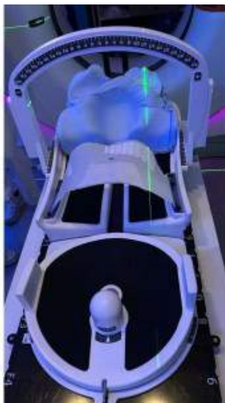
Figura 1. Sistema de inmovilización empleado para SBRT de mama multifracción.
