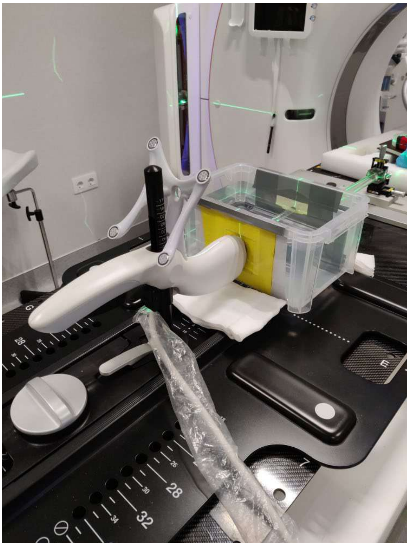
FIGURA 1: Maniquí para el control de calidad del sistema de control intrafracción prostático Clarity (Posicionamiento de la sonda ecográfica)
