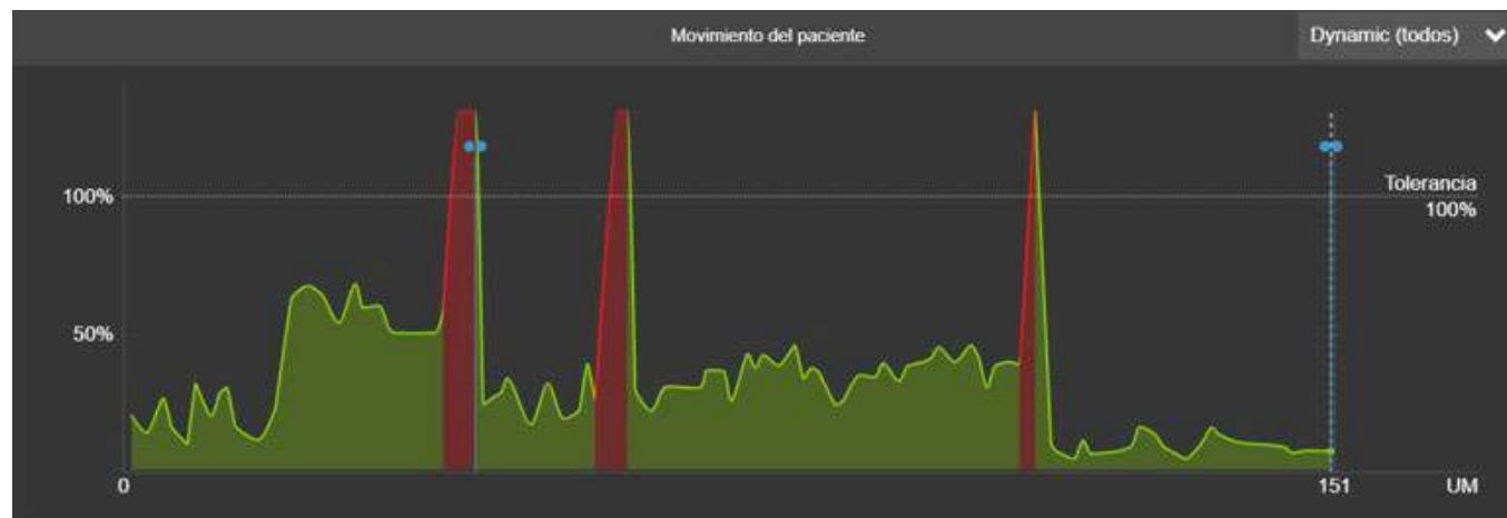
FIGURA 2. Curva del movimiento de la superficie del paciente. En rojo, franjas fuera de tolerancia con interrupción del tratamiento; en azul, instantes de adquisición de imágenes de rayos X de comprobación.
