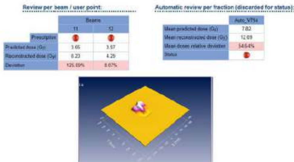
Figura 2. Caso 2: Desviaciones de una de las sesiones de tratamiento junto con la reconstrucción del valor de pixel recogida por el EPID
