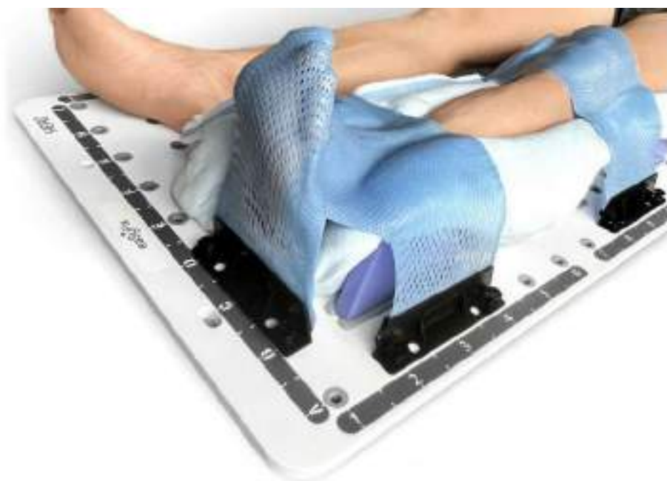
Figura 1: Plataforma eaSyFix. Se dispone con adaptadores acolchados y zonas de indexación para máscaras termoplásticas, asegurando una alta reproducibilidad.
