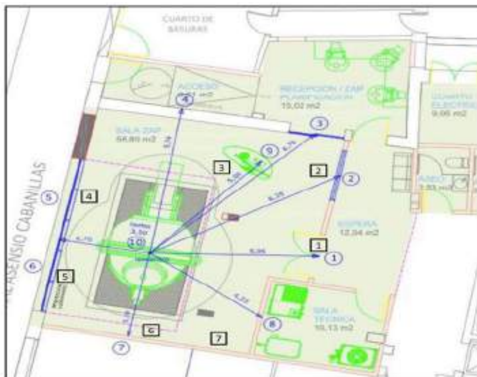
Figura 1. Plano de la instalación donde se muestran los diferentes puntos de medida de tasa de dosis (azul) así como la ubicación de los dosímetros de área (negro).
