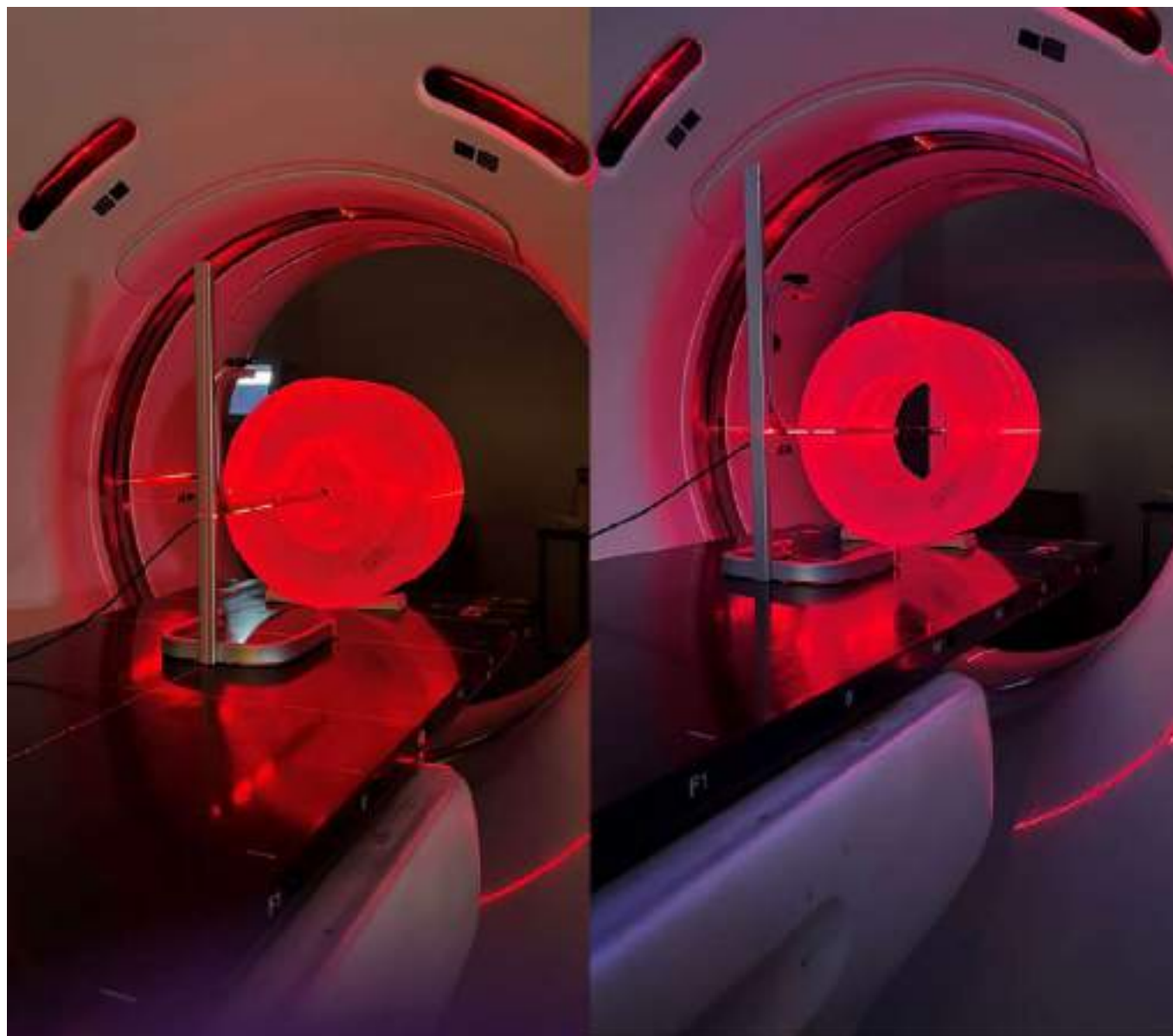
FIGURA 1. Configuraciones empleadas para medir dosis: a) con el fantoma completo, b) sólo con la corona de 32 cm de diámetro externo.
