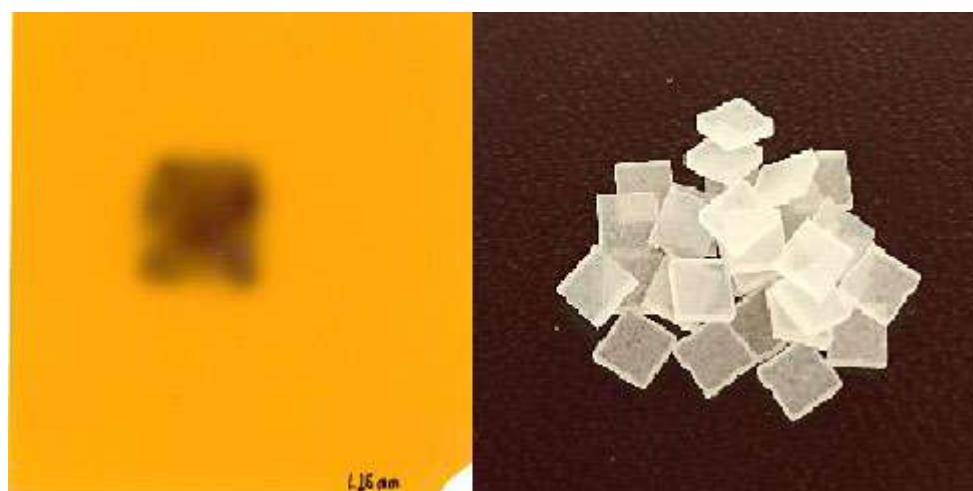
FIGURA 1. Radiocrómicas y dosímetros termoluminiscentes utilizados para la medir la dosis absorbida.
