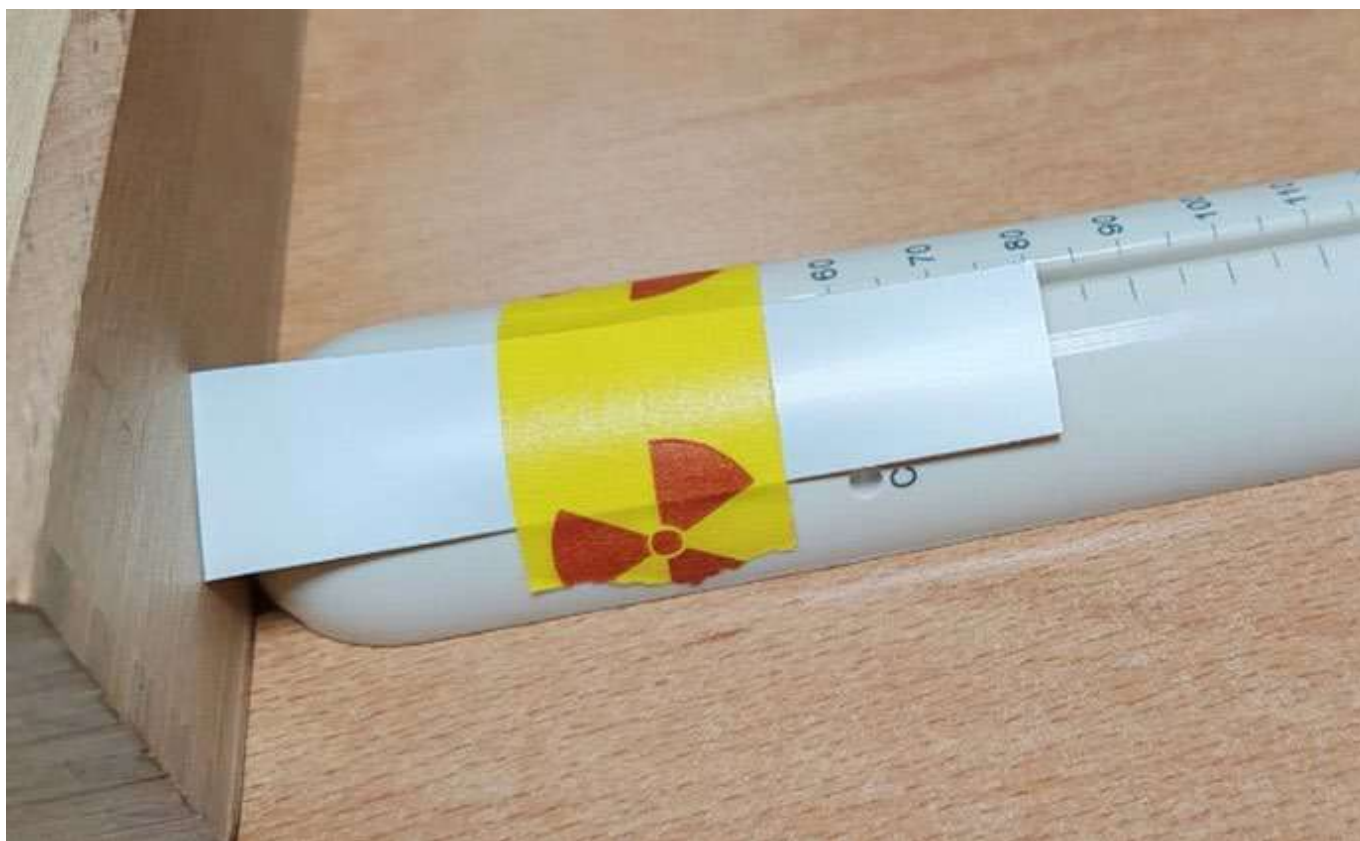
FIGURA 1. Montaje de la película radiocrómica sobre el aplicador para la medida.
