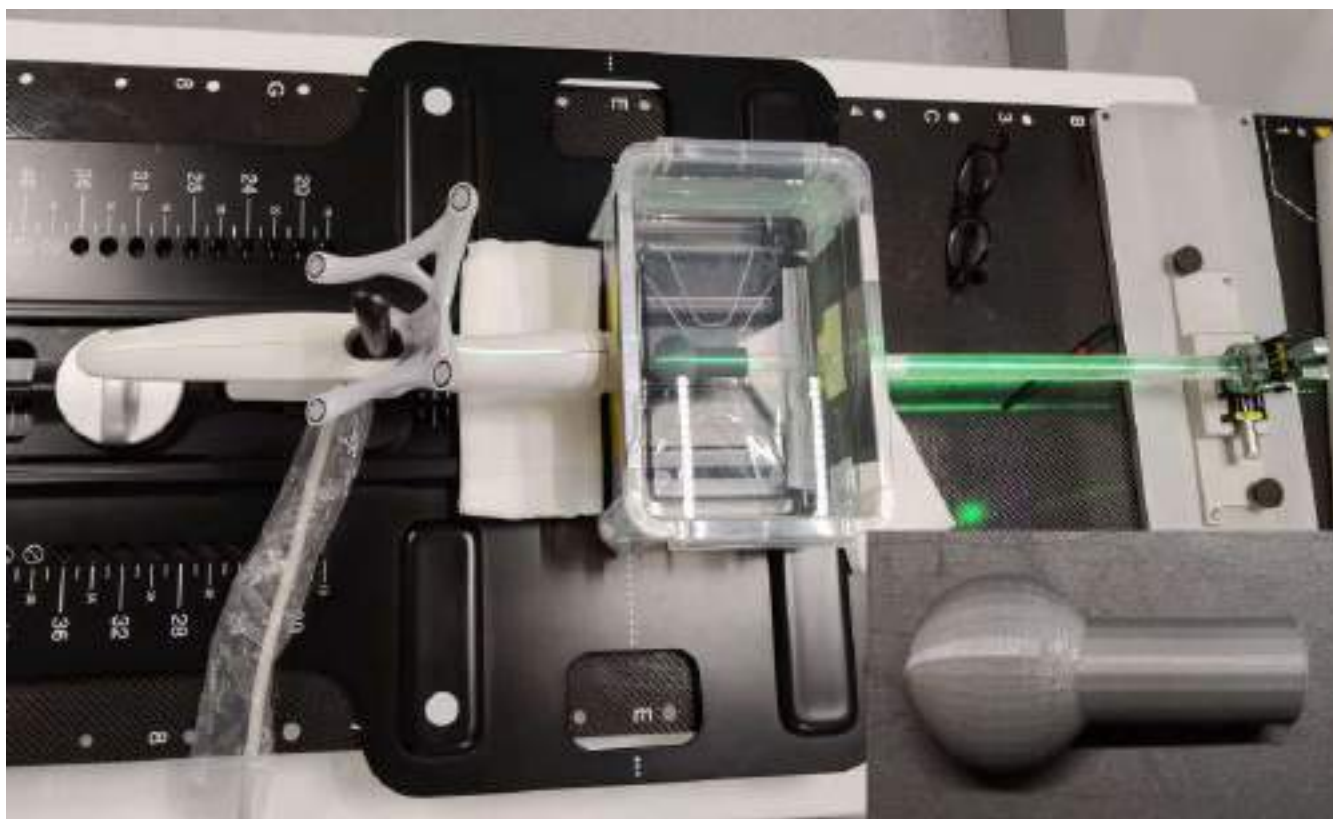
FIGURA 2: Maniquí para el control de calidad del sistema de control intrafracción prostático Clarity (Vista cenital del montaje completo y el fantoma prostático)
