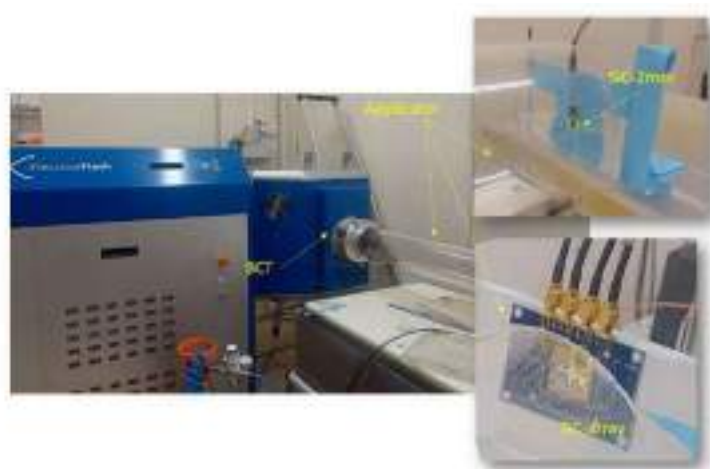
Figura 1. Izquierda: Imagen del ElectronFLASH LINAC en el Instituto Curie. Derecha: sensor de SiC-2mm (arriba) y sensor de SiC-array (abajo). Ambos sensores están posicionados al final del aplicador del haz y conectados a sus respectivos electrómetros.
