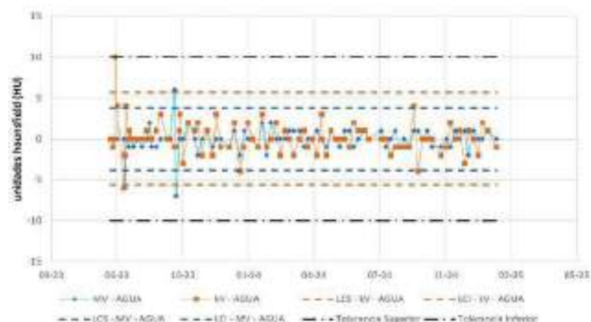
Imagen 1: Datos de calibración en el tiempo del sistema de MVCT y KVCT en maniquí de agua sólida. Se han calculado los Límites de Control Superior (LCS) e Inferior (LCI).
