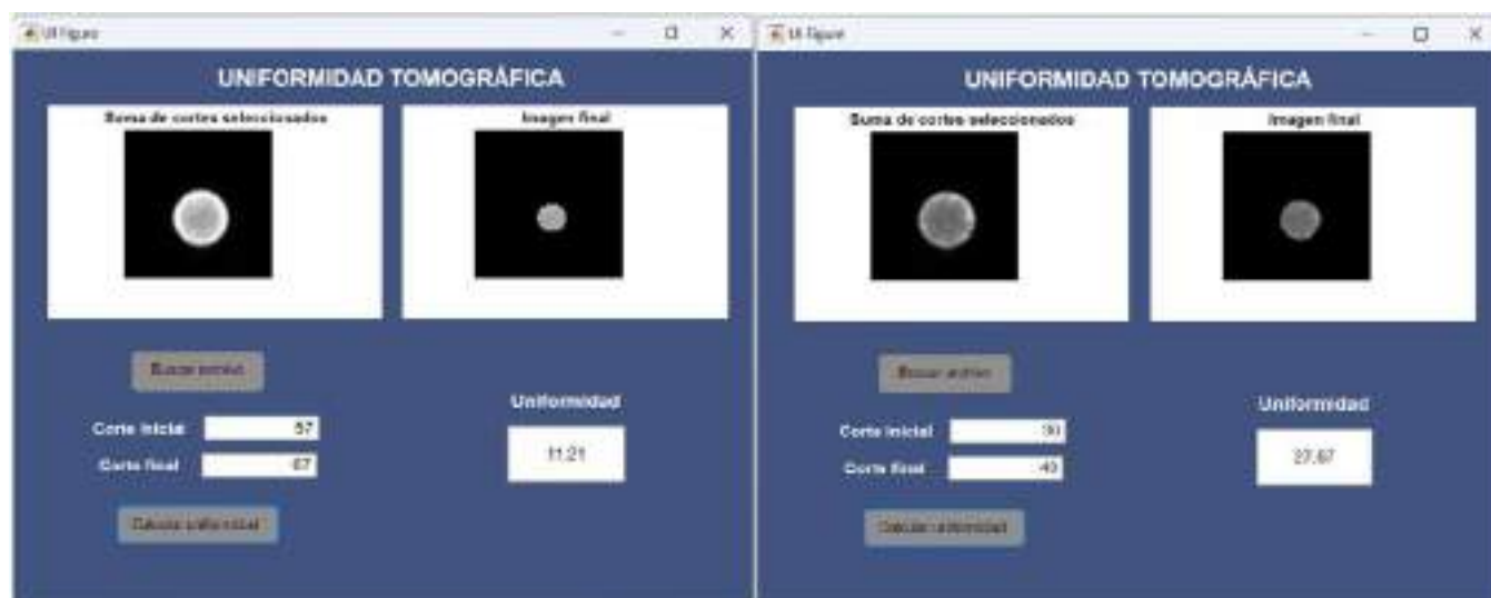
FIGURA 1. A la izquierda, resultado de la uniformidad tomográfica para el módulo de uniformidad. A la derecha, resultado de la uniformidad tomográfica para un módulo no uniforme.
