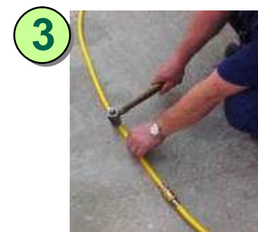
3 Intentar reparar con un martillo y retraer el portafuentes al interior del contenedor accionando el telemando
