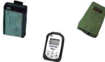
Dosímetros Lectura Directa con alarma acústica
