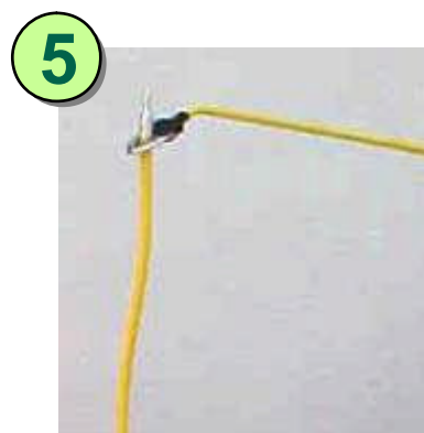
5 Sacar el portafuentes de la manguera e introducir el portafuentes al revés en el conducto del contenedor
