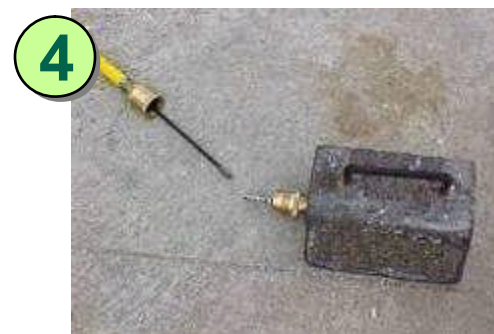
Conectar el portafuentes al cable propulsor del telemando y extraer el portafuentes al contenedor accionando el telemando
