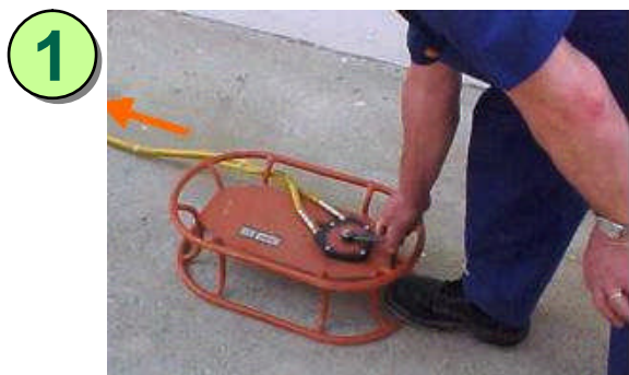
1 Empujar el portafuente hasta el puntal accionando la manivela del telemando
