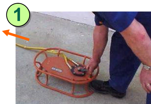
Empujar el portafuente hasta el extremo del puntal accionando la manivela del telemando
