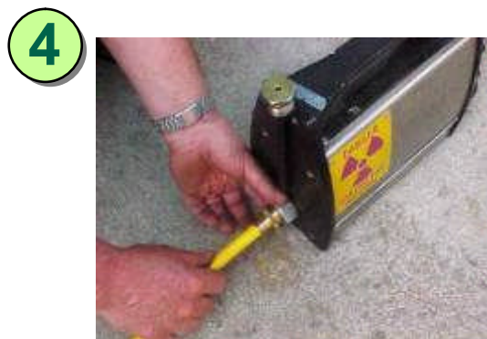
1 Empujar el portafuente hasta el puntal accionando el telemando
