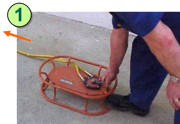
1 Empujar el portafuente hasta el puntal accionando el telemando
