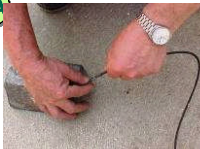
Conectar el portafuentes al cable conductor
