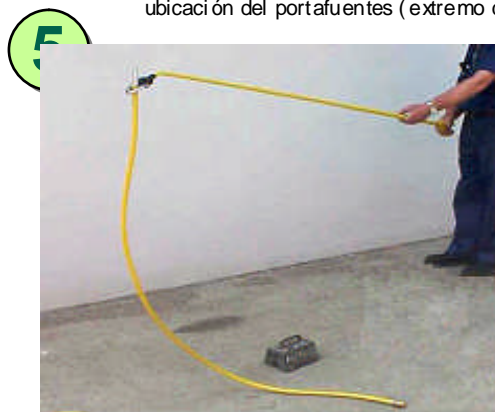
5 Con la ayuda de unas telepiñzas sacar el portafuentes de la manguera
