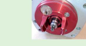
Verificar que el terminal hembra del porta-fuentes asoma completo por el conector trasero y no tiene daños (partes rotas o deformadas). Si hay alguna duda, verificarlo con la galga
