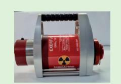
Verificar la limpieza del contenedor, comprobando que el tetón de la conexión con el telemando está en su posición
