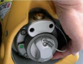
**10** Verificar que el adaptador de salida no presenta abolladuras ni desgaste excesivo
