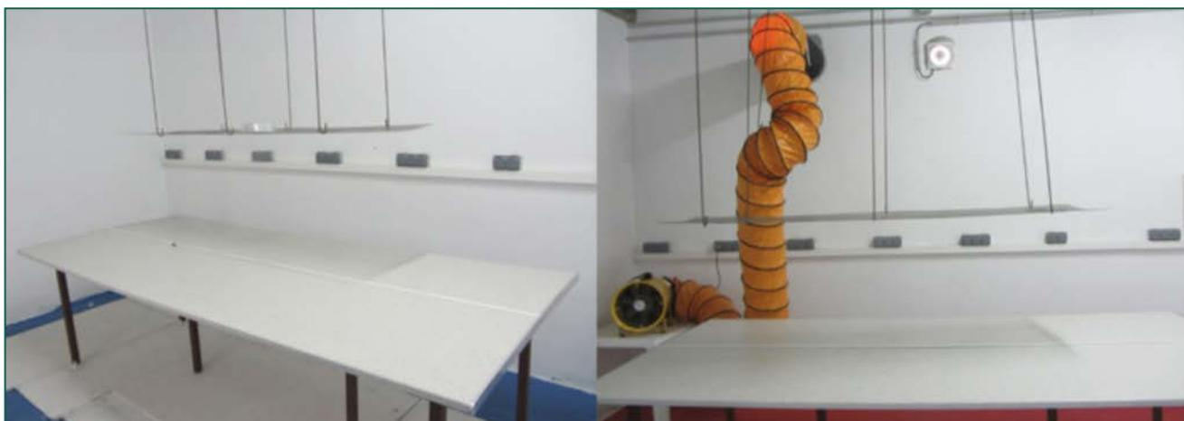
**Figura 2.** Detalle de las dos habitaciones empleadas como cámaras de radón con sistema artificial de ventilación instalado en una de ellas.
