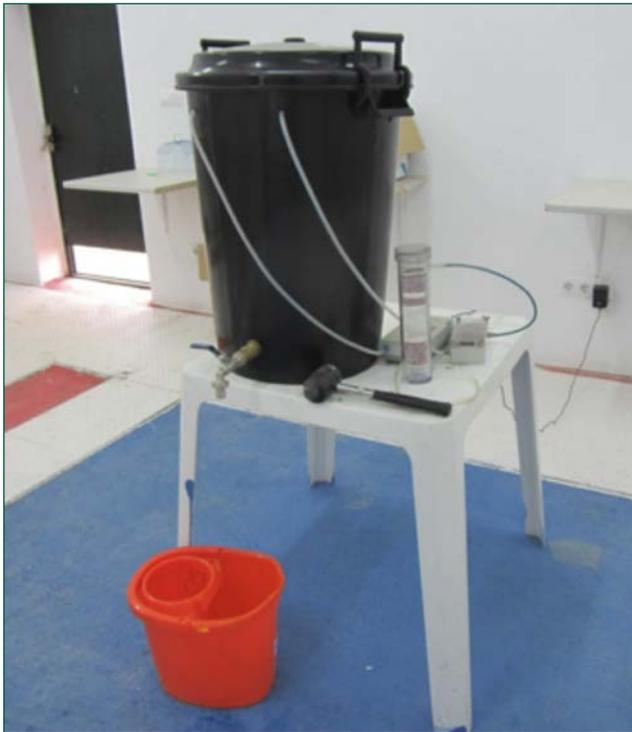
**Figura 3.** Detalle del dispositivo empleado para el ejercicio de medida de gas radón en agua.
