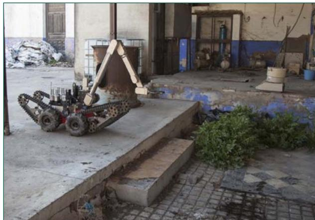
Robot NRBQ Telemex del GIETMA.
