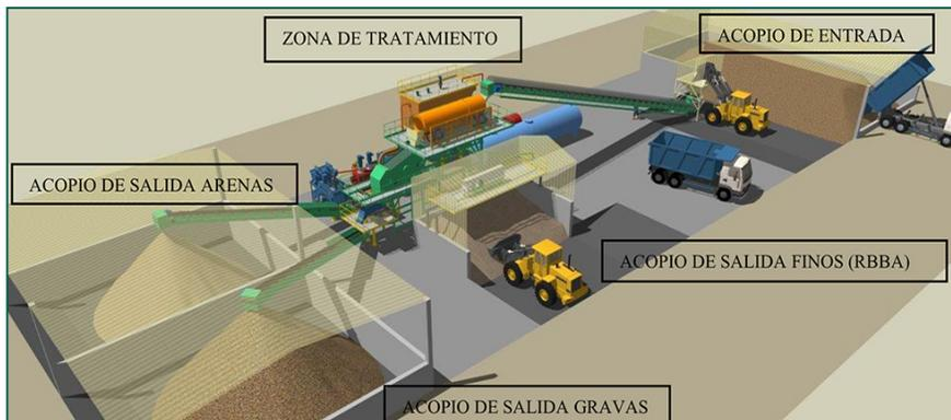
**Figura 1.** Esquema de la planta de lavado de suelos.
