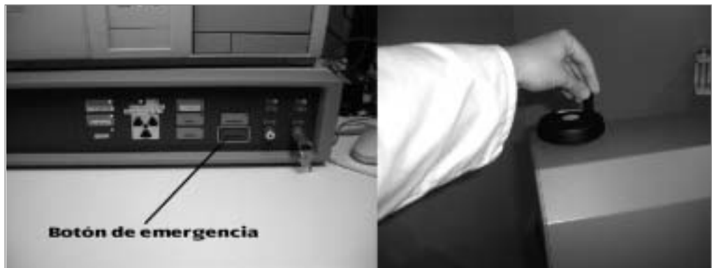
Fig 2. Consola de mando y manivela de retracción manual.
