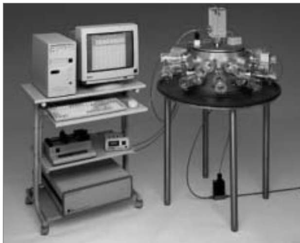
Figura 2. Sistema de inhalación de aerosoles para animales de experimentación recientemente adquirido por el CIEMAT.
