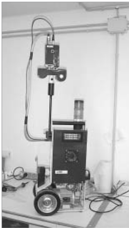
Figura 5. Baliza de control radiológico ambiental.
