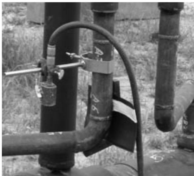
Figura 1. Control mediante gammagrafía industrial.
